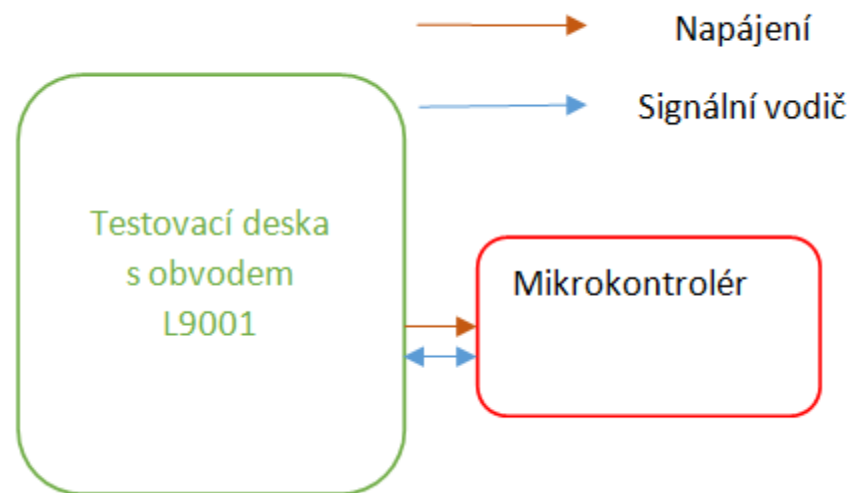
Obrázek 14: Základní blokové schéma měřícího obvodu.
